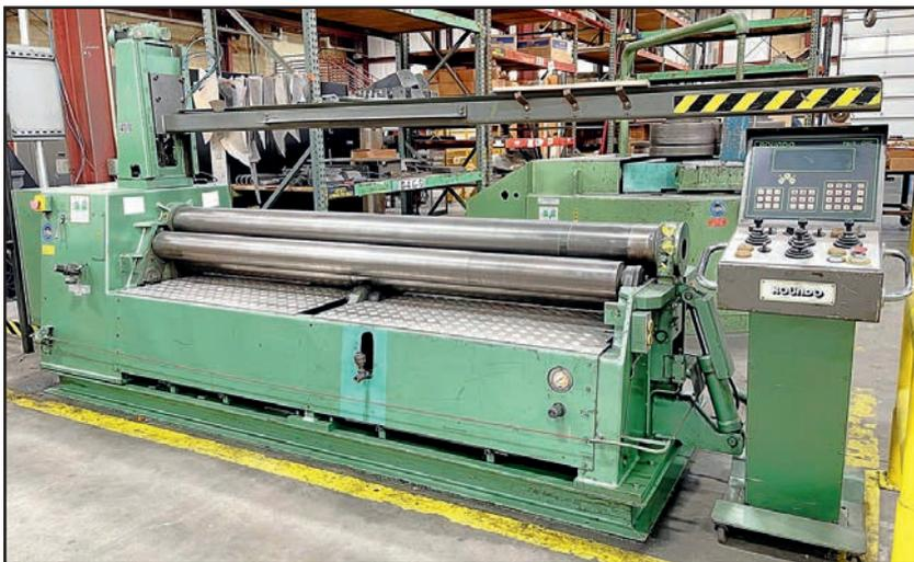
ROUND PASS-185 4-ROLL CNC PLATE BENDING ROLL
