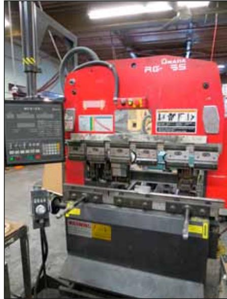
Amada RG-35s, 38 Ton, NC9-EX-II 3-Axis CNC
