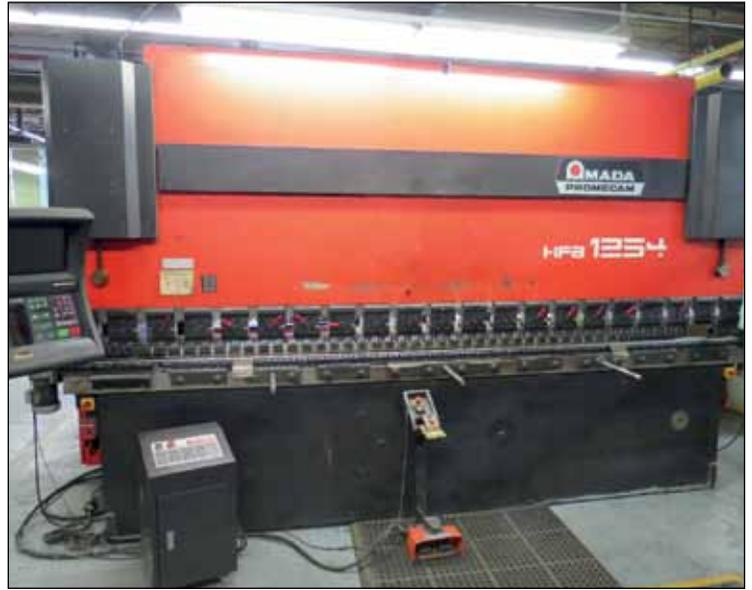
Amada Promecam HFB125-4, 138 Ton, Operateur 4 Axis CNC
